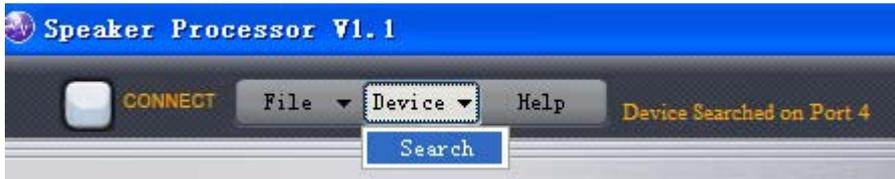
点击“Device”——“Search”，软件会自动搜索联机线的COM端口号，搜索完成后，点击“CONNECT”，软件会与机器连接。
