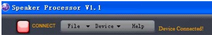
部分机器版本需你确认你的USB联机线的COM口，在这里的串口设置需与“我的电脑\管理\设备管理器\端口（COM和LPT）”的端口号一致，然后，点击软件中联机按钮即可。
